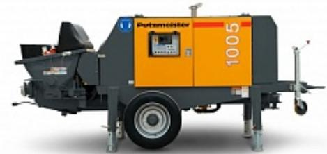
Стационарный бетононасос **Putzmeister BSA 1005 E C**. Насос оснащен мощным электродвигателем, оборудование применяется в тоннелях и на объектах с низким уровнем разрешенного шума. Насос оснащен микропроцессорной системой управления и регулировки EPS (Ergonic Pump System). Подает бетон с максимальной фракцией **до 32 мм на высоту до 50 - 60 метров, по горизонту - до 100 метров.**
